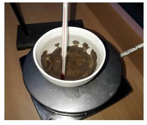
Спек выщелачивали в течении 30 минут при температуре  $75C^0$ , периодически взбалтывая содержимое в стакане
