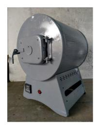
Произвели спекание при  $t = 1250-1300 \, \text{C}^0$ , 2 часа
