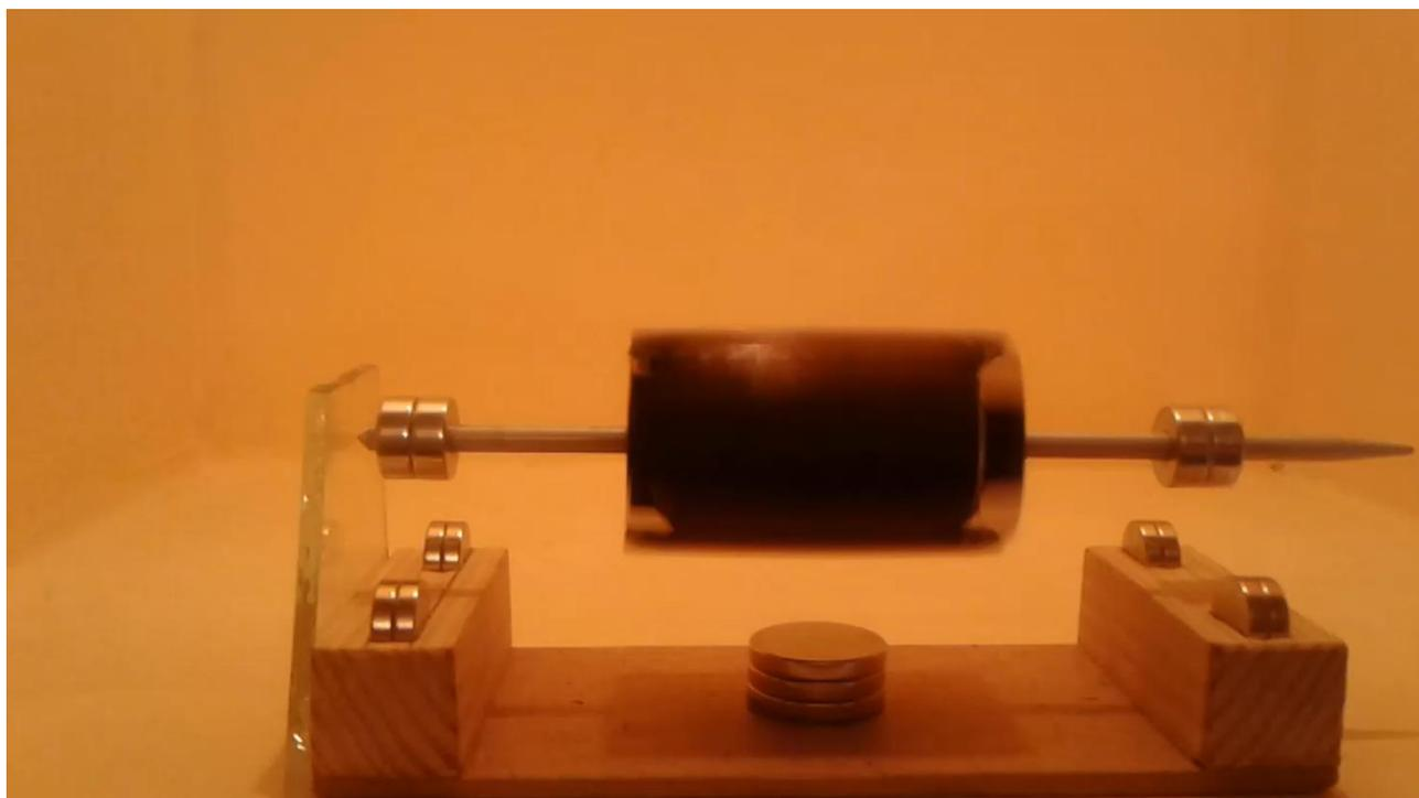
Рис. 8 Левитирующий двигатель в действии
