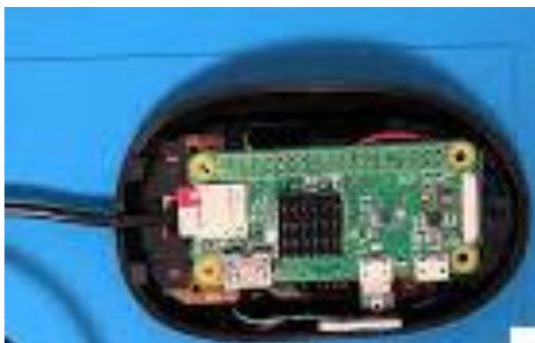
Рис. 3. Компьютерная мышь с вмонтированным в неё микрокомпьютером Raspberry PI Zero W
