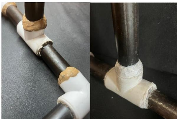
Рис. 2.3.10. Укрепление опорной конструкции холодной сваркой и последующая ее маскировка
