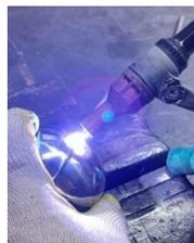
Рис. 2.3.3. Процесс сварки двух чаш сварочным аппаратом
