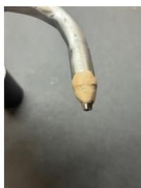
Рис. 2.3.6. Присоединение металлического наконечника от шариковой ручки к выходному отверстию сопла
