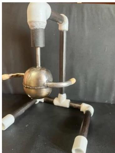
Рис. 2.3.11. Паровая машина Герона в сборке
