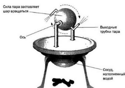
Рис. 1.3.1. Схема работы парового двигателя Герона Александрийского
