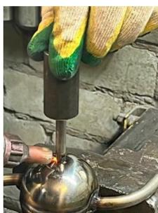
Рис. 2.3.5. Процесс сварки сферы, сопел и вала
