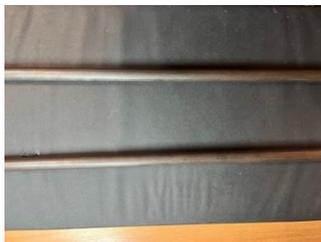
Рис. 2.3.7. Труба после обработки наждачной бумагой
