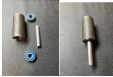
Рис. 2.3.1. Труба, вал и подшипники до и после сборке
