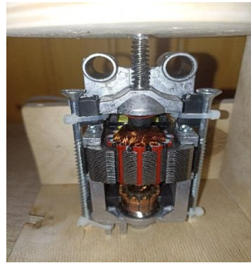
Рисунок 1.12 Установка электромотора с диском
