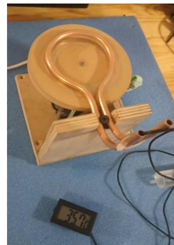
Рисунок 1.19 Температура при высокой мощности мотора
