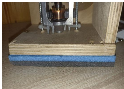
Рисунок 1.15 Установка антивибрационной поролоновой подкладки
