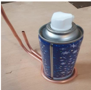
Рисунок 1.11 Придание нужной формы медной трубке
