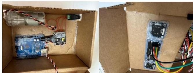
**Рисунок 2.27-2.28 Размещение комплектующих и подключение LED дисплея**
