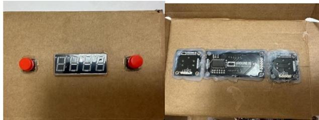
**Рисунок 2.23-2.24 Установленные кнопки и LED дисплей**
