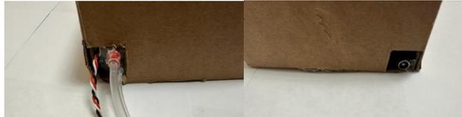
**Рисунок 2.21-2.22** Отверстия для водяной помпы и гнезда питания
