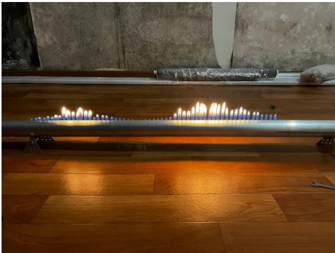
Рисунок 2.24 Вид волны при частоте 600 Гц
