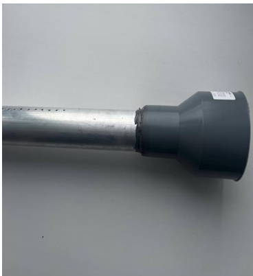
Рисунок 2.16 Труба с переходником насадки
