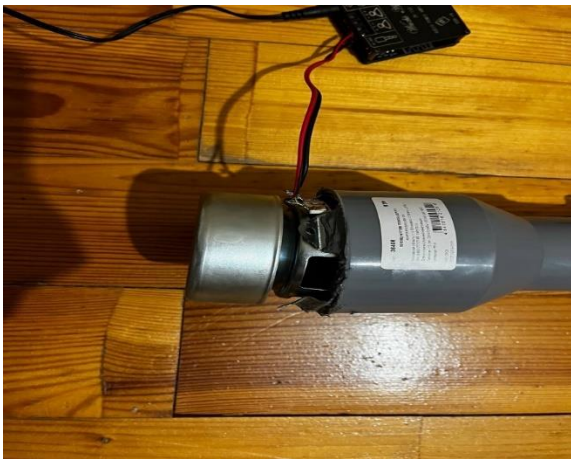
Рисунок 2.20 Динамик с припаянным усилителем звука
