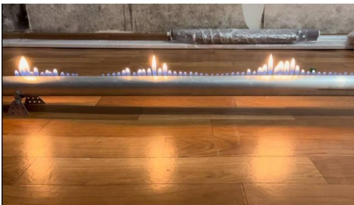
Рисунок 2.26 Вид волны при частоте 1000 Гц
