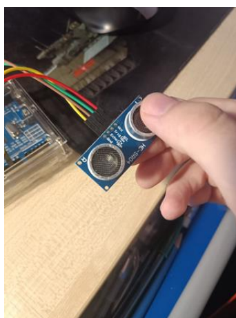
Подключение к микросхеме УЗ-датчика HC-SR04
