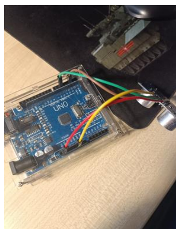
Подключение к микросхеме УЗ-датчика HC-SR04
