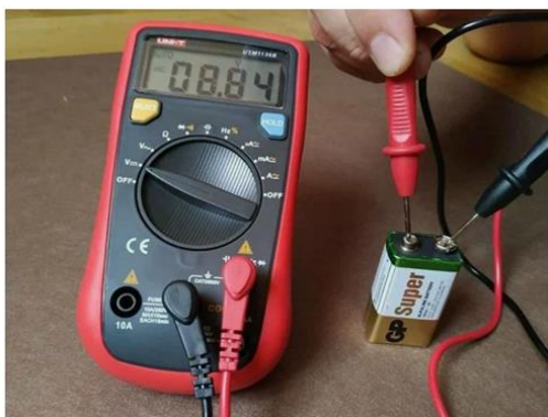
Проверка мощности батареи «Крона» мультиметром
