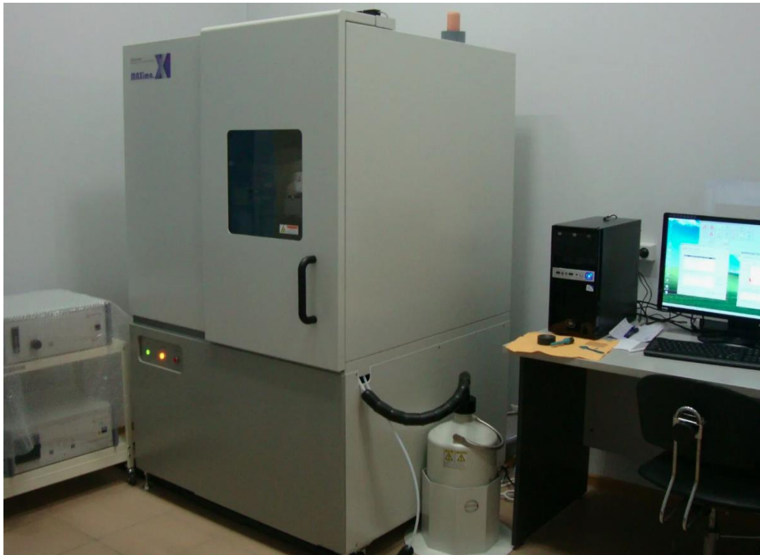
Приложение 4. Аппарат для проведения РФА.
