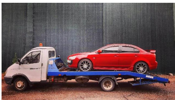
Рисунок 6. Буксировка способом полной погрузки.
