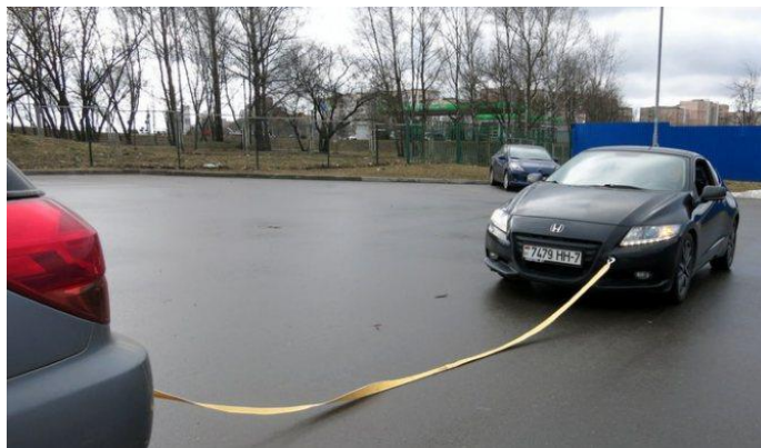
Рисунок 3. Буксировка на гибкой сцепке.
