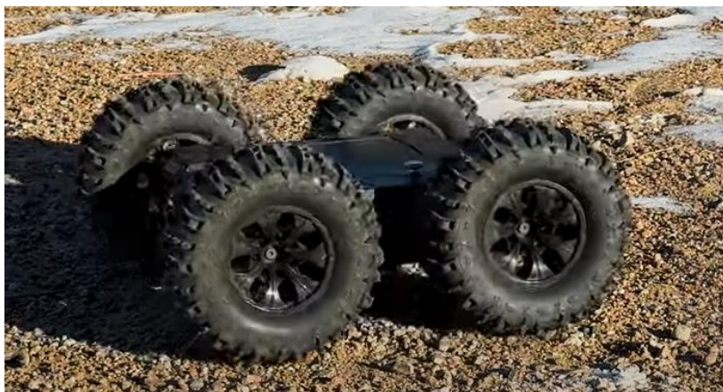
Рисунок 4. – Тележка с четырьмя независимыми приводами
