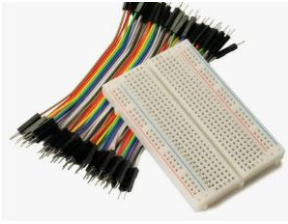
Макетная плата, набор проводов «Мама-Папа»
