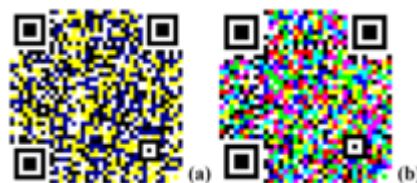
Рис. 9 – Примеры цветного двухмерного кода большой емкости (HCC2D): (a) 4-цветный код HCC2D и (b) 8-цветный код HCC2D.
