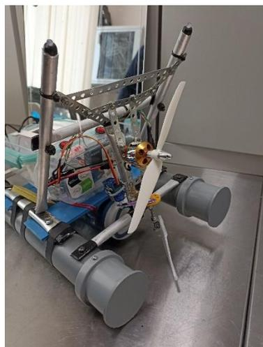
Фото положения двигателя и сервопривода
