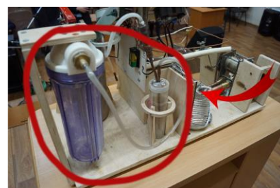
Рис.4 Система фильтрации полученного водорода
