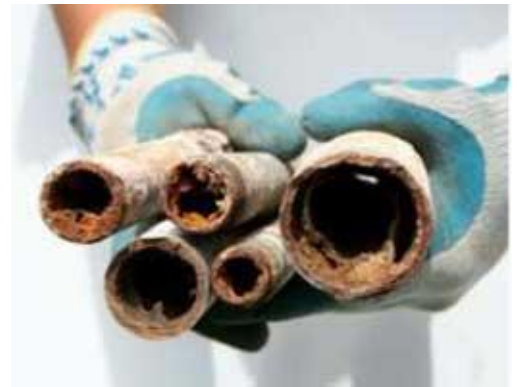
Рисунок 1 . Стальных труб в которых образуется ржавчина, которая делает канал бугристым и повышает его гидравлическое сопротивление.
