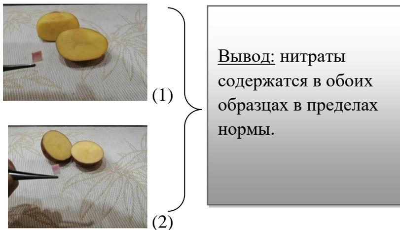
*Рисунок 4. Определение нитратов в картофеле с помощью тест-полоски.*
