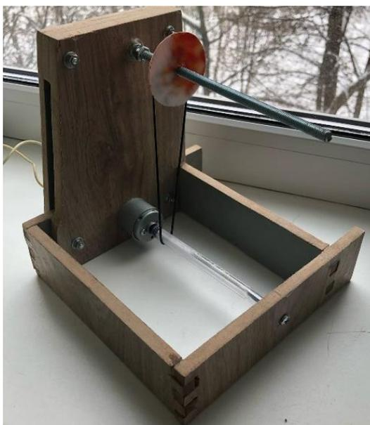
Рис.3.2. Деревянная основа с электродвигателем
