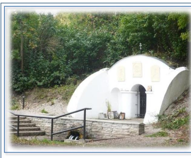
Родник хорошо обустроен: подземные воды поступают наружу по металлической трубе диаметром 10 см, которая заключена в керамическую трубу длиной 3,0 м. Расход воды – 0,5 л/сек. Вода в колодце без запаха, прозрачная (прозрачность 60 см), приятная на вкус. Температура воды в зависимости от времени года 5,0 – 7,0 °С. Родниковый ручей шириной 0,5 – 1,0 м и глубиной 5,0 – 10,0 см несет воды в пруд со скоростью 1,5 м/сек. Дно ручья каменистое, русловые берега покрыты водно-болотной растительностью. К
