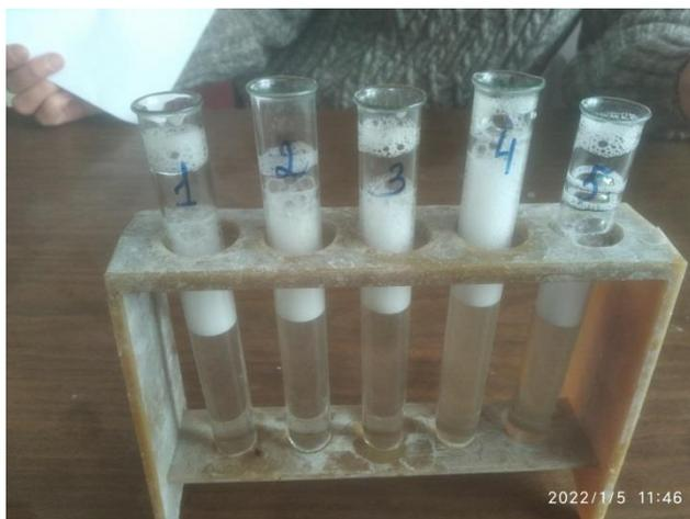
Рисунок 8. Определение жёсткости
