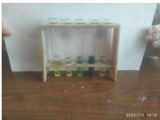
Рисунок 14. Качественное определение ионов  $\text{Fe}^{2+}$
