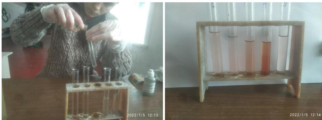
Рисунок 13. Определение ионов  $\text{Fe}^{3+}$
