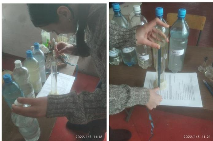
Рисунок 4. Определение прозрачности воды
