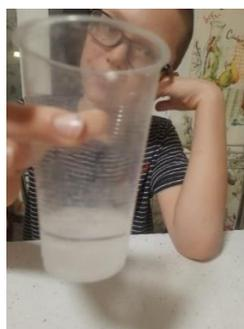
*Опыт №6. Налили воду комнатной температуры, уровень обозначили маркером и вынесли на улицу (температура воздуха – 26°С). После полного замерзания, уровень льда поднялся на 1 мм. Вода при замерзании действительно расширяется.*
