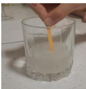
*Опыт №7. Очистка воды от уксусной кислоты путём проведения реакции нейтрализации.*
