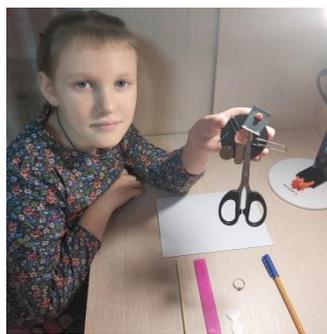
*Вывод:* магнит притягивает только некоторые металлические предметы (железо, сталь), и не притягивает цветные металлы. Бумага, пластмасс, дерево не испытывают его притяжения.
