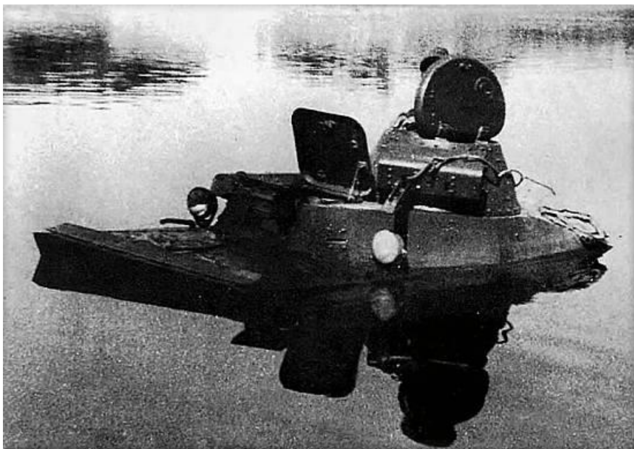
Рис.5. Советский малый плавающий танк т-40
