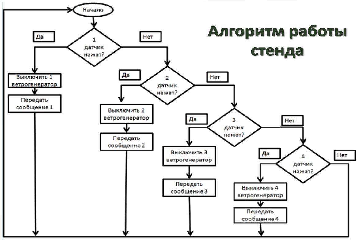
Рис. 9 Алгоритм работы стенда
