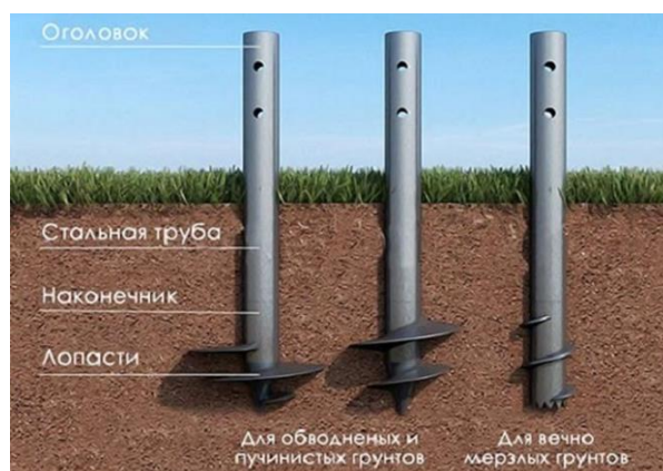
Фото 6. Технология установки винтовых свай.
