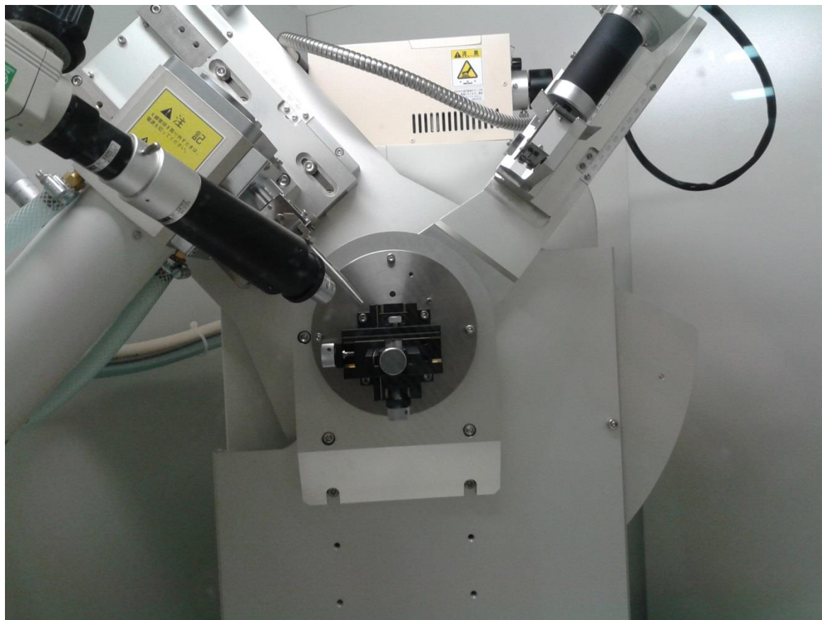
Рентгеновская трубка, столик, детектор (рис.5)
