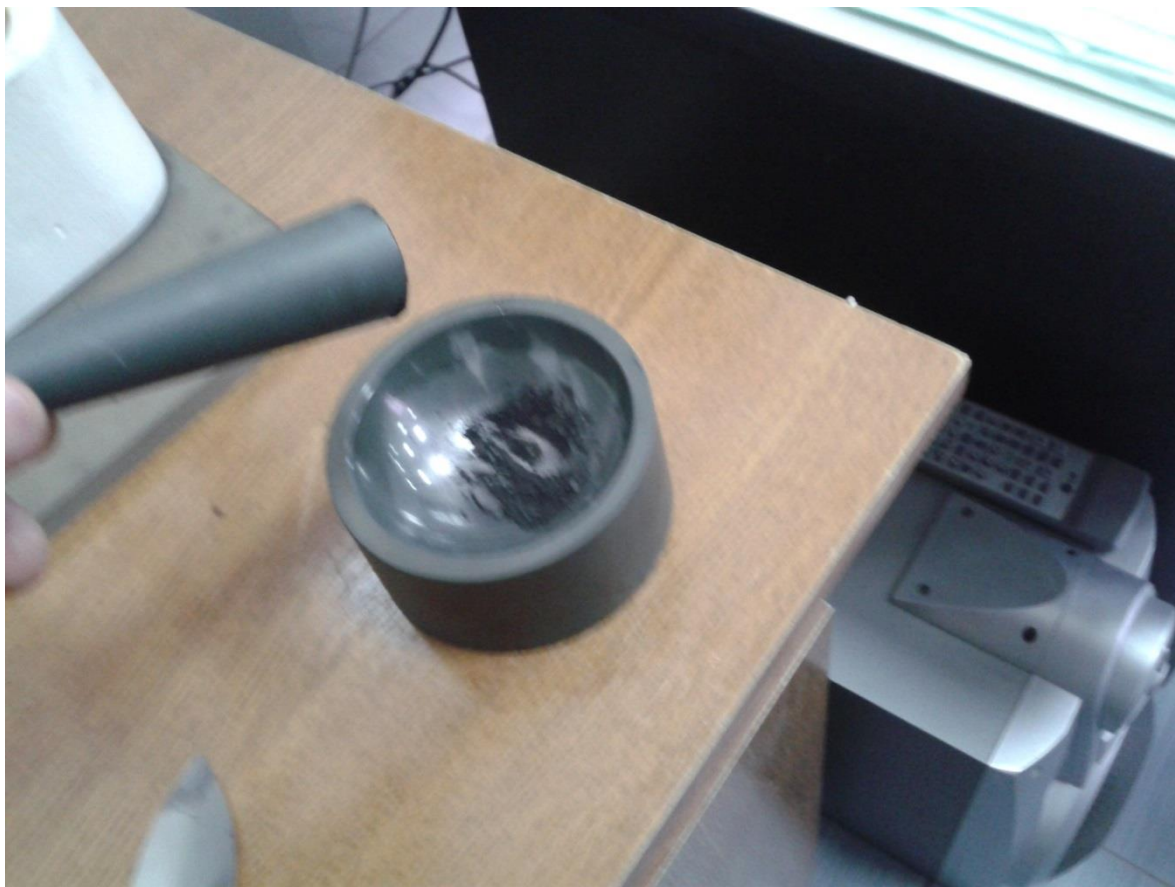
Рис.2. Агатова Ступка для измельчения графита (рис.6)
