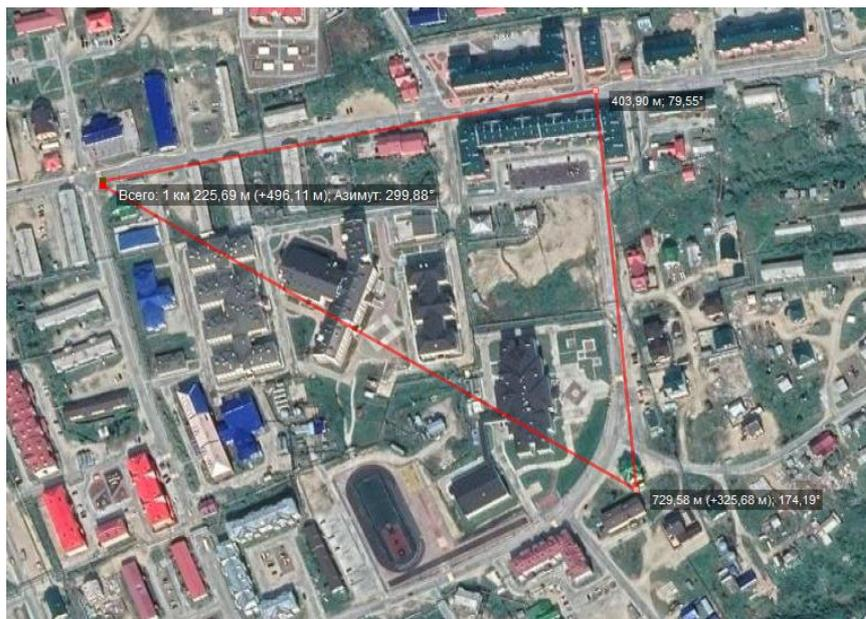
Фото 6. Определение площади стока ливневых вод. Участок №1
