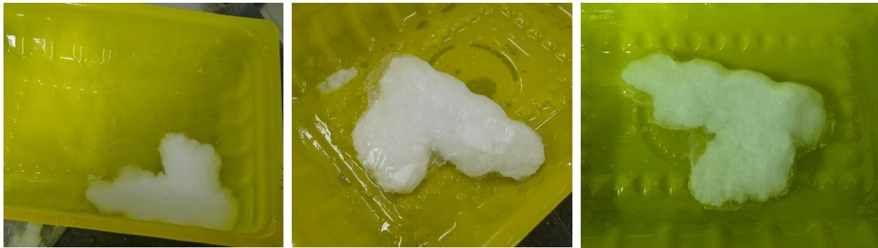
Фото 6,7. Образование кристаллического сгустка при вымораживании -40^{\circ}\text{C}
