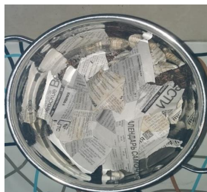
Рис 2. Смесь из использованной чайной заварки и макулатуры в соотношении 1:2 соответственно
