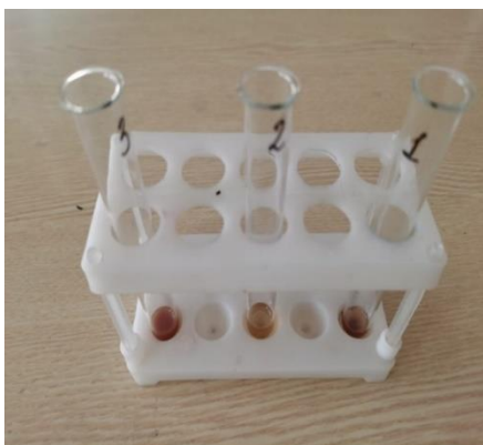
Рис 3. Экстракт после установления устойчивой окраски при добавлении молибденовокислого аммония
