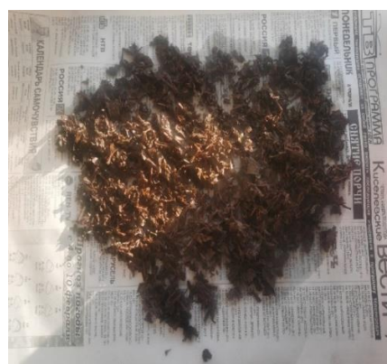
Рис 2. Смесь из использованной чайной заварки и макулатуры в соотношении 1:2 соответственно
