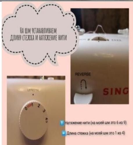
Длину стежка устанавливаем на 1, а натяжение нити на 6.
