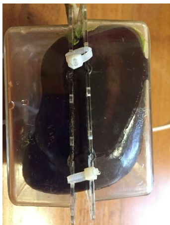
Рис. 17. Форма под давлением плода разошлась
