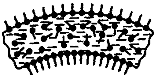
Рис. 1 Структура мыльной пленки, (гидрофильные золи) укрепленной ПВА мыла
