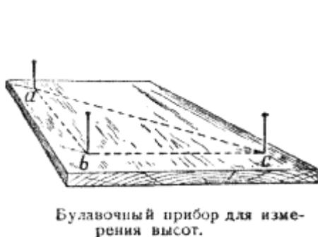
Булавочный прибор для измерения высот.
