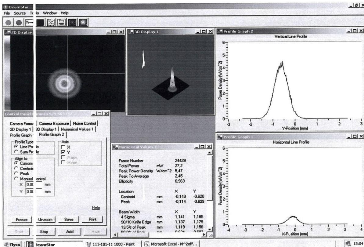
Рис.2 Структура лазерного пучка на выходе, полученная с помощью ПЗС-камеры на экране компьютера.
