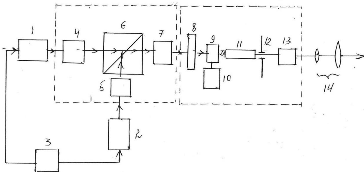
Рис. 1. Функциональная схема излучателя лазера с диодной накачкой для возбуждения фотолюминесценции.
