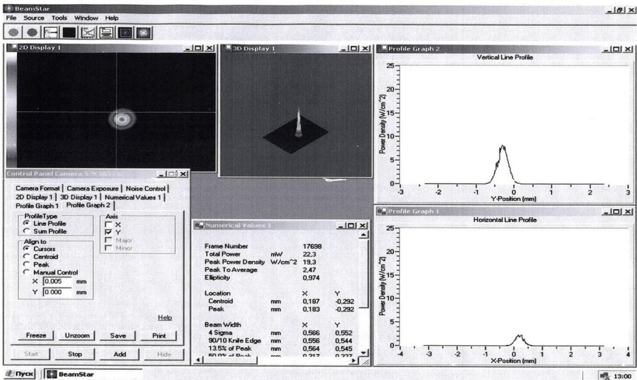
Рисунок 3. Структура лазерного пятна в фокусе метровой линзы, полученная с помощью ПЗС-камеры на экране компьютера.
