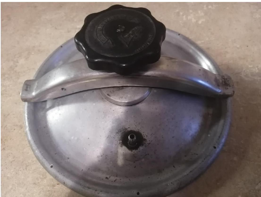
Рис.3 Герметичная крышка с отверстием для выхода воздуха
