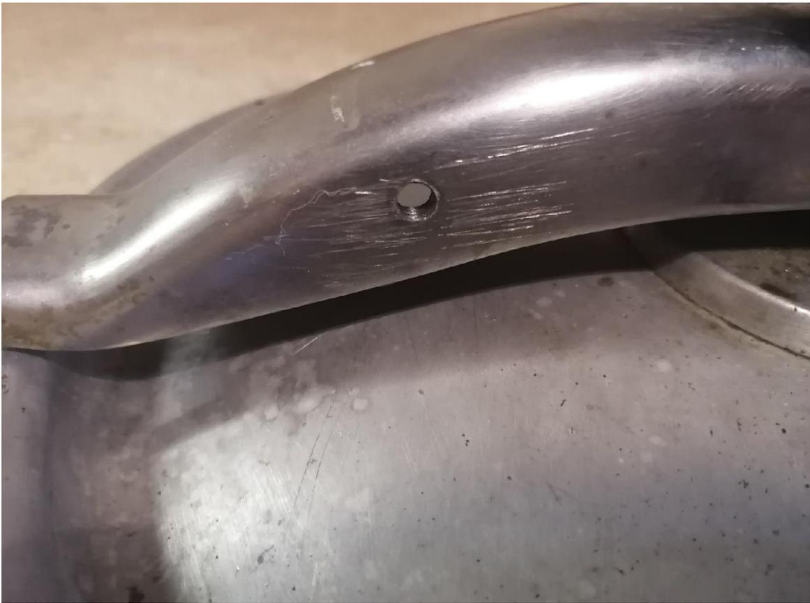
Рис.4 Отверстие для крепления вентилятора
