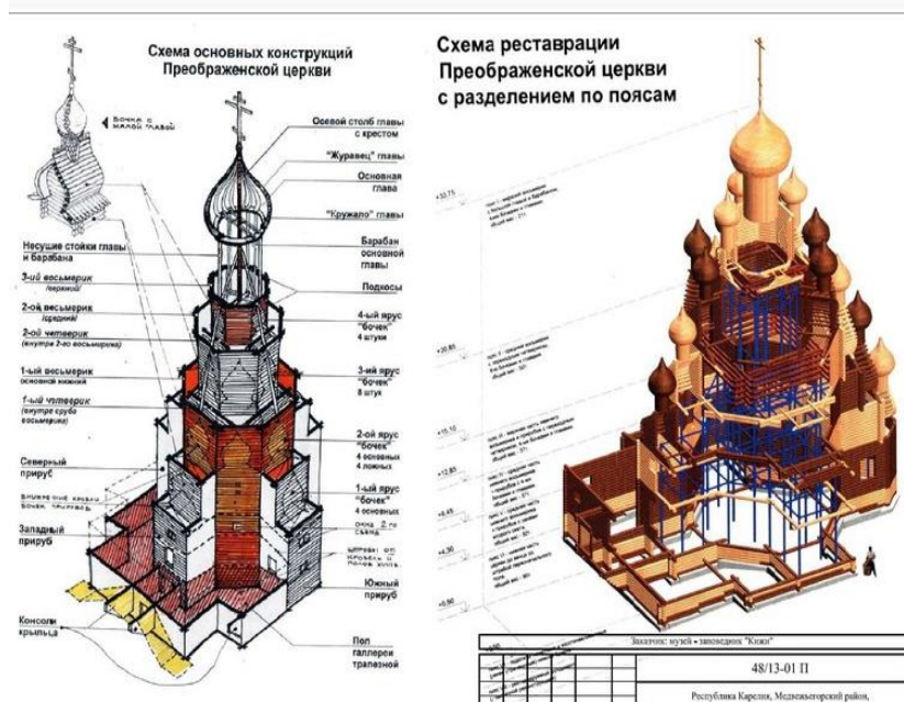
Рис.2. Схема основных конструкций Преображенской церкви и схема реставрации
