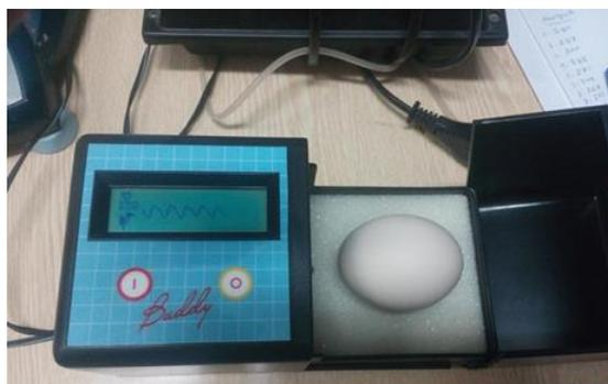
**Рисунок 3 – Прибор Бадди для определения ЧСС эмбриона.**
