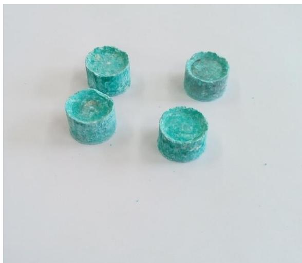
Рисунок 7. Прессованный осадок гидроксикарбоната меди (II)
