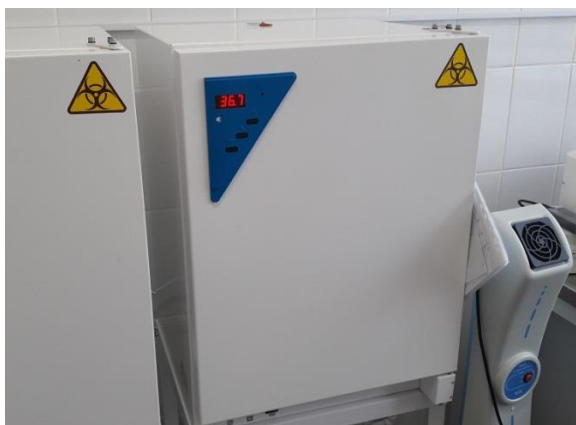
Рис.2.1.7. Шкаф-термостат для выращивания бактерий при 36.7С.
