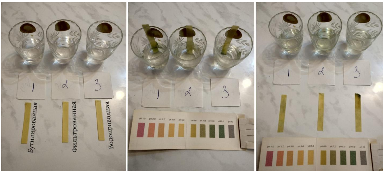
Фото 8. Тест на определение pH – фактора воды
