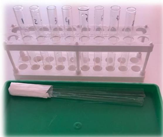
Рис.2. Стерилизованное подготовленное оборудование для отбора проб (пробирки, стеклянные палочки)
