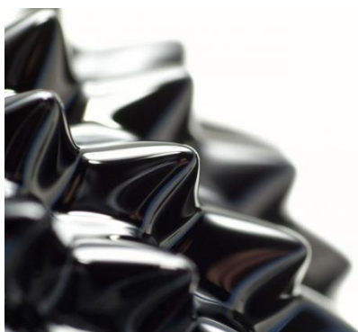
Рис. 1 "Ёжик" магнитной жидкости при хорошем приближении
