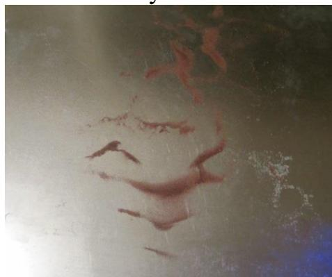
**Опыт 3** Получение фигур Хладни с помощью звукового генератора при частоте выше 750 Гц.
