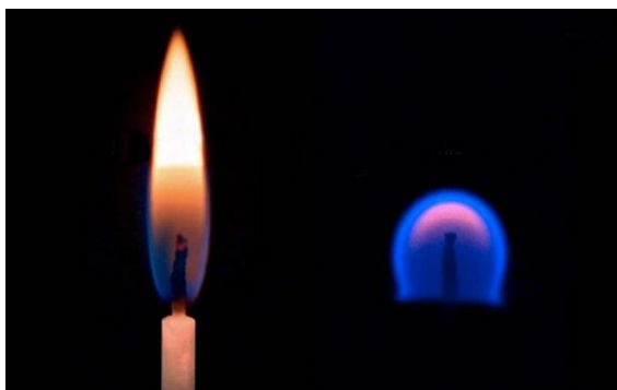
Рис. 12. Вид пламени свечи на земле (слева) и в невесомости (справа)
