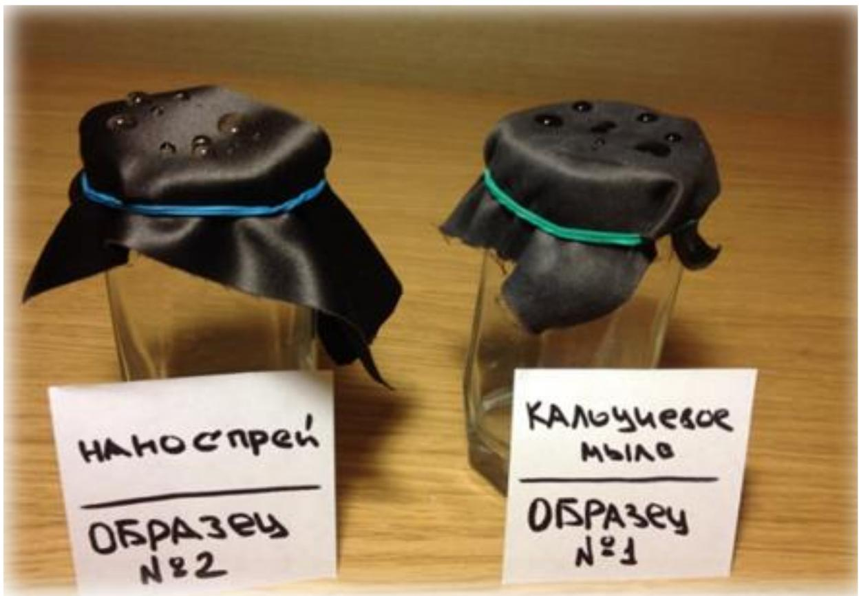
Рис. 4. Испытание образцов на гидрофобность
