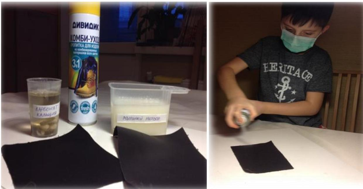
Рис. 3. Образцы ткани обработанной ацетатом кальция и водоотталкивающим спреем.
