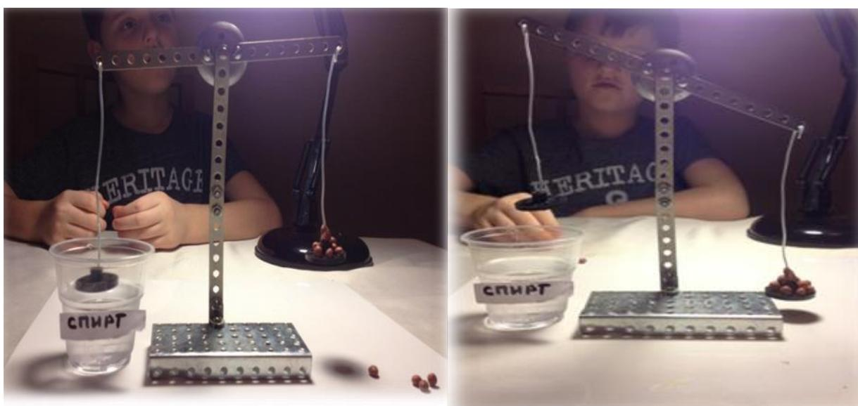
Рис. 4. Измерение силы поверхностного натяжения спирта
