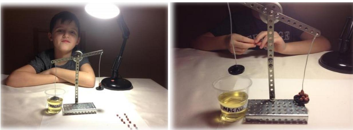
Рис. 5. Измерение силы поверхностного натяжения масла
