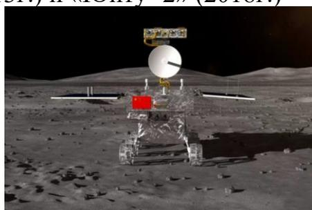
«Юйту-2» («Нефритовый заяц-2»), 2018г, вес 140 кг, длина 1,5 метра, ширина 1 метр, высота 1,1 метра. Луноход оснащён 2 складными панелями солнечных батарей и 6 колесами, исследует темную сторону луны.
