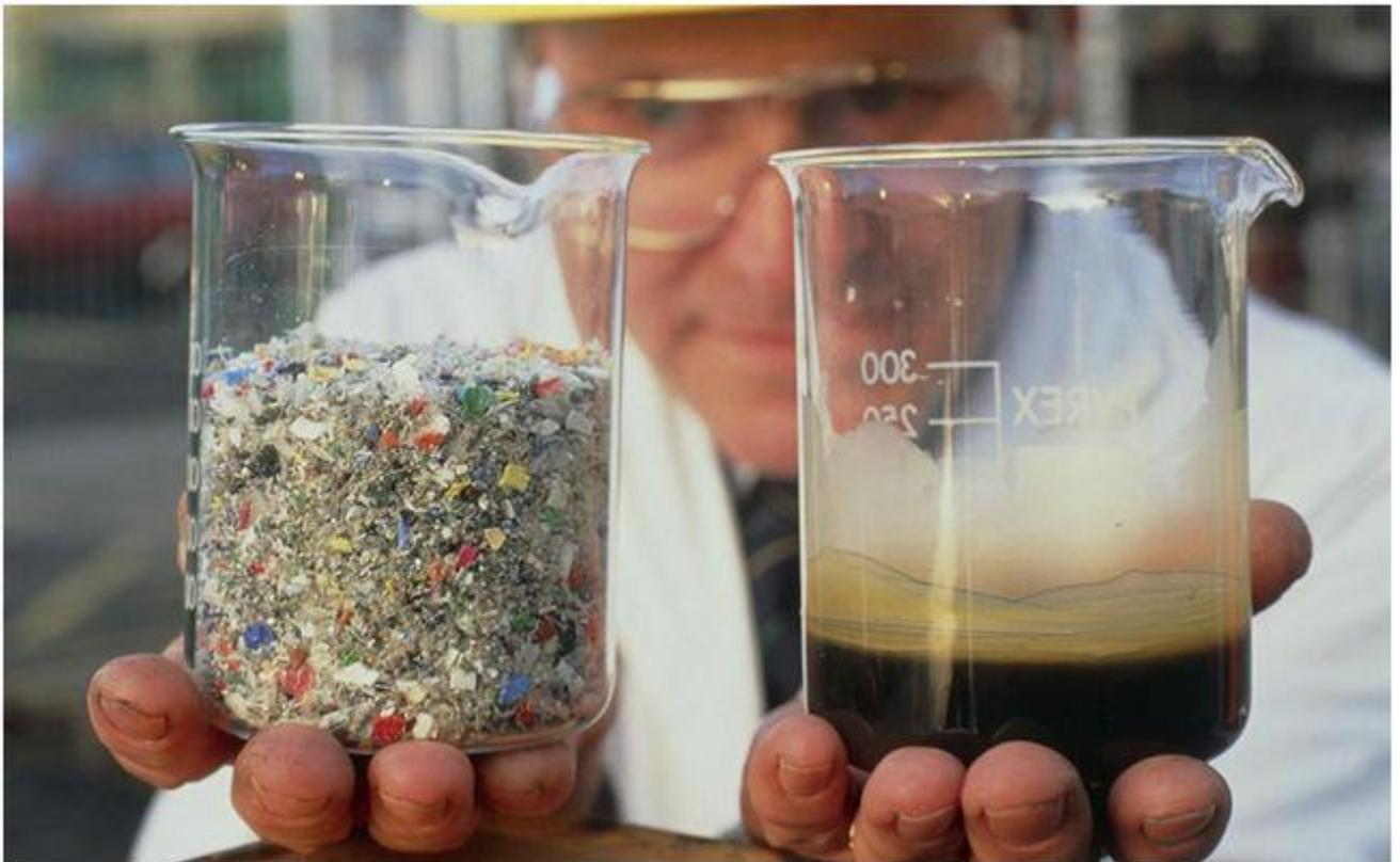
Пример того, как из полимеров получают жидкое топливо методом пиролиза.
