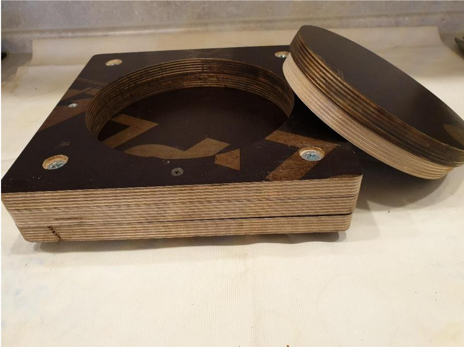
Чем точнее и аккуратнее будет собрана коробка или сделана форма, тем точнее и аккуратнее будет блок. Это будет важно позднее, когда будем извлекать блок из формы. Древесина — пористый материал, а расплавленный пластик — очень липкий.
