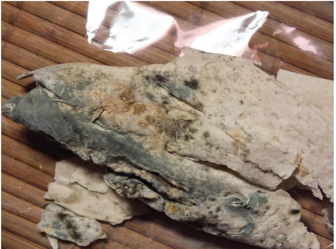
**Рисунок 25. День 3 Образец №2 (полиэтилен, комнатная температура)**
