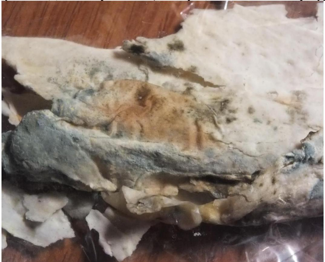
**Рисунок 17 День 1 Образец №2(полиэтилен,комнатная температура)**
