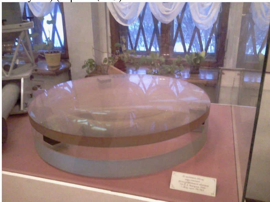
Рисунок С.8 Фотографический объектив диаметром 820 мм, который предполагалось установить после войны в новом большом рефракторе (Д.Д. Максудов) (страница 15)
