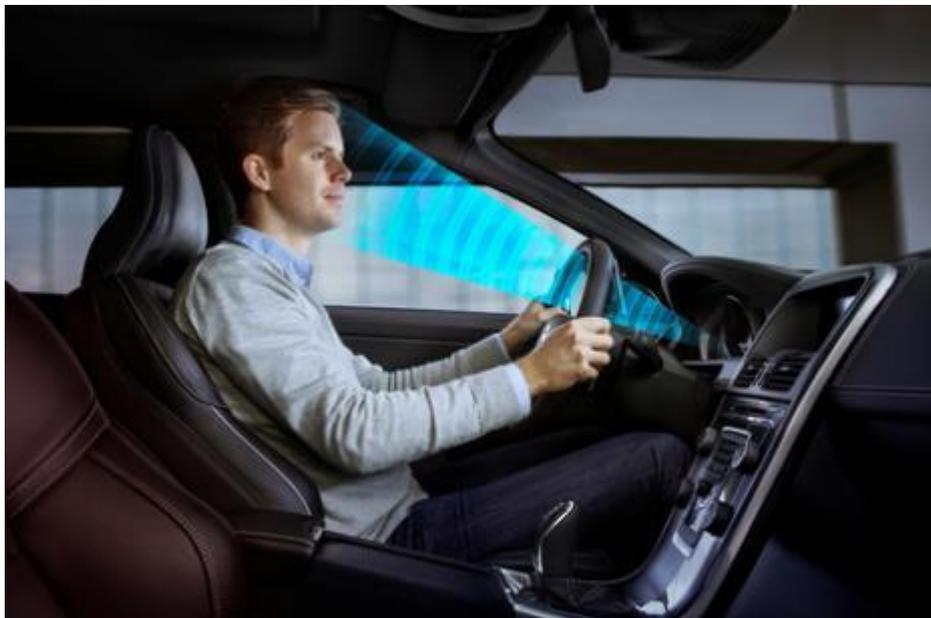
Рис. 5. Система отслеживания усталости водителя, основанная на использовании инфракрасной камеры.
