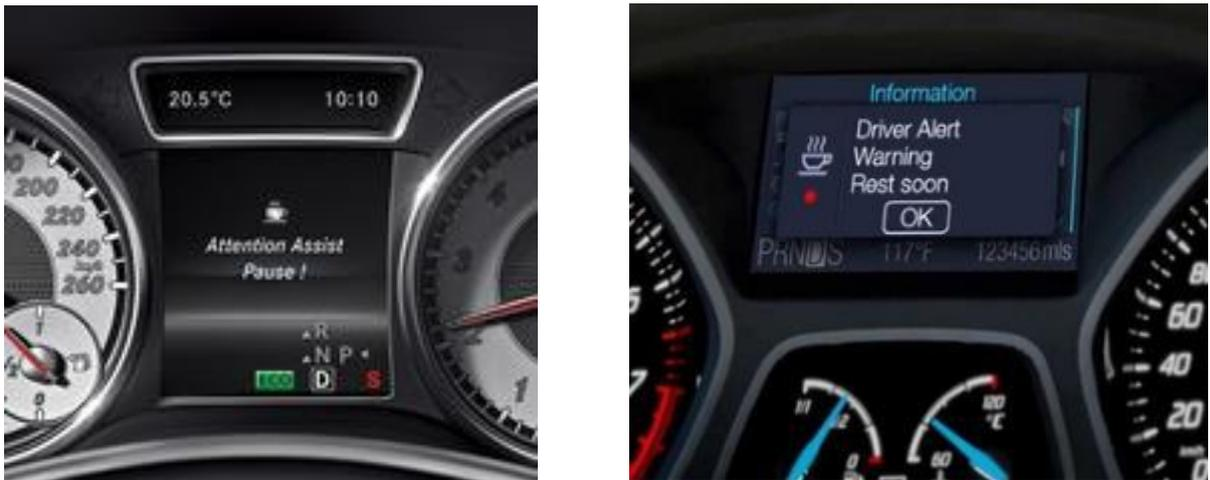
Рис. 4. Системы предупреждения об усталости водителя Mercedes-Benz и General Motors.
