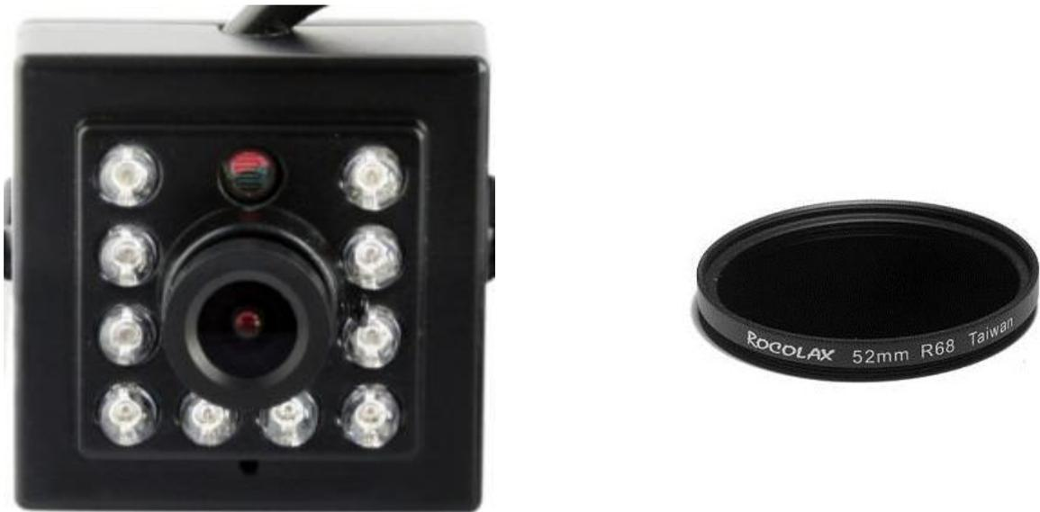
Рис. 7. Видеокамера прибора в корпусе (для изготовления прибора используется только плата с ПЗС – матрицей) и инфракрасный фильтр подсветки, и объектива.
