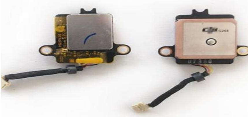
Рис. 14. Оригинальная плата GPS для DJI Phantom 4 PRO.
