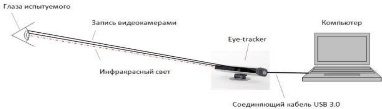
Рис.2. Схема работы прибора «Eye-tracker».
