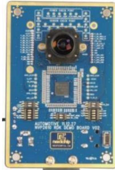
Рис. 10. Модуль камеры ELP-USBFHD01M интегрированный на панели процессора NVP2610, со снятой подсветкой.
